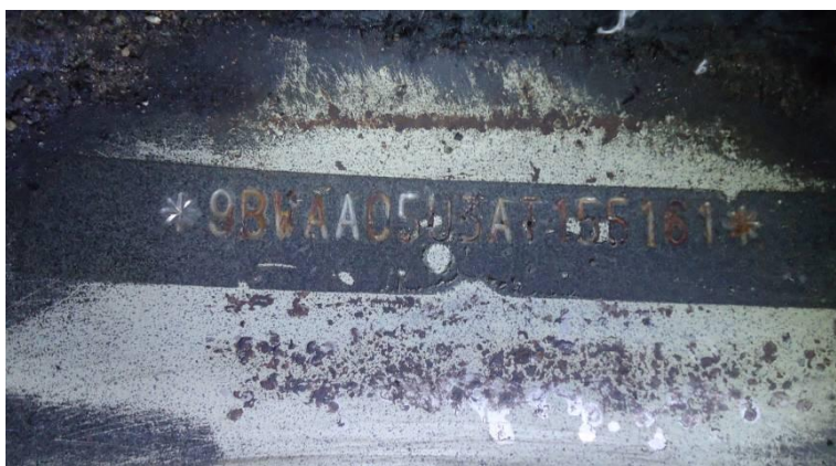
Fotografia 02: Imagem da numeração de chassi.
